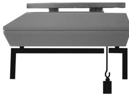
Afbeelding 1 Instellen van de weegschaal voor ondergrondse wegingen
